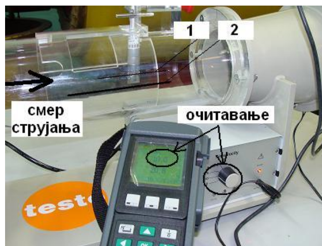
Слика 3. Позиционирање сонде у аеротунелу: 1 - оса сонде и аеротунела, 2 - маркер на зиду аеротунела.
