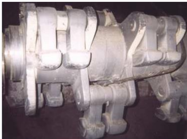
Slika 4.1. Prevlake nanete navarivanjem na čekiće u cilju sprečavanja habanja
