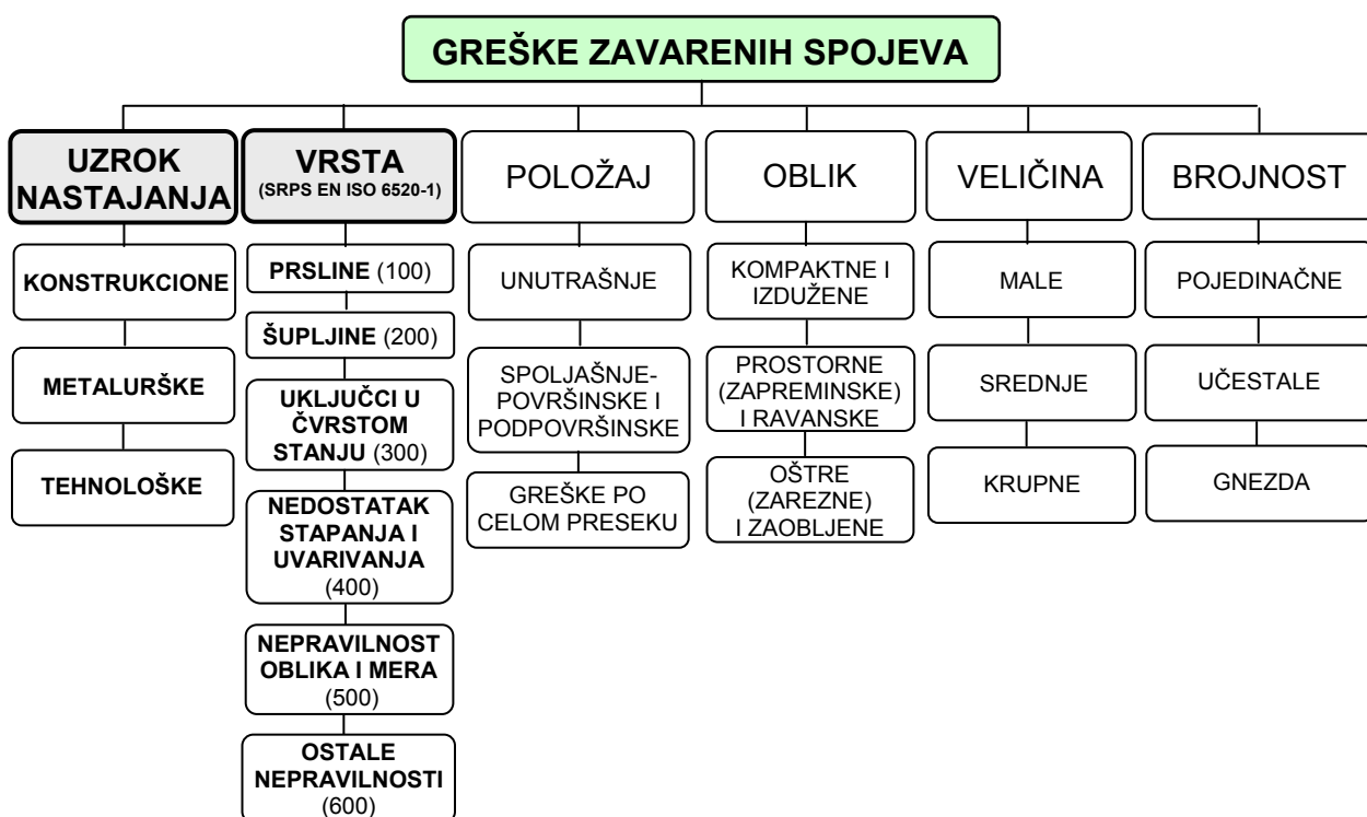
Slika 16. Klasifikacija grešaka zavarenih spojeva
