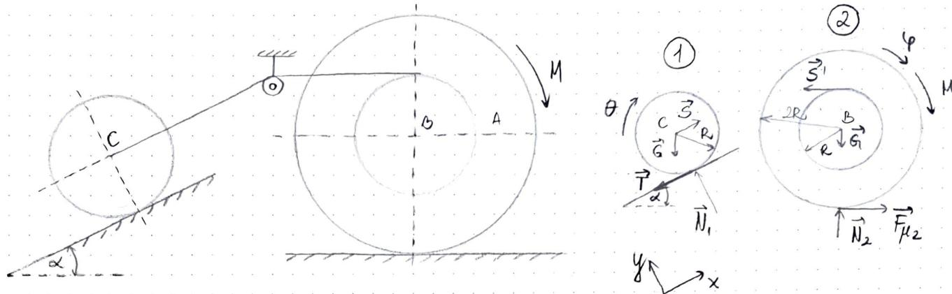
$$(2) \frac{d\vec{\omega}}{dt} + \vec{v}_Q \times \frac{G}{g} \vec{v}_C = \vec{M}_Q \Rightarrow \text{ЗАКОН ПРОМЕНЕ МОМЕНТА КОЈ. КР. ЗА ПОКРЕТНИ ПОЈИ } Q$$
