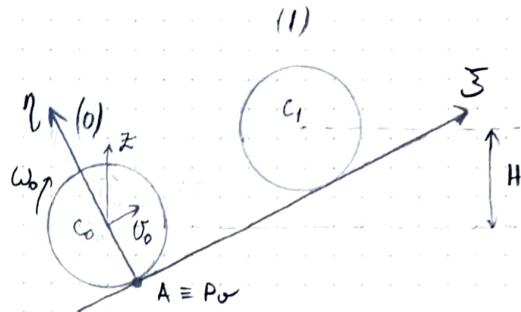
\* ПОШТО ЈЕ  $v_C = \text{const}$ , А ТАЧКА А ЈЕ ПОЈ БРЗИНА  $\Rightarrow$  ТЕЈО ИМА 1 СТЕПЕН СЛОБ. И КРЕТАЊЕ ЈЕ ОДРЕЂЕНО КООДИНАТОМ  $\varphi$
