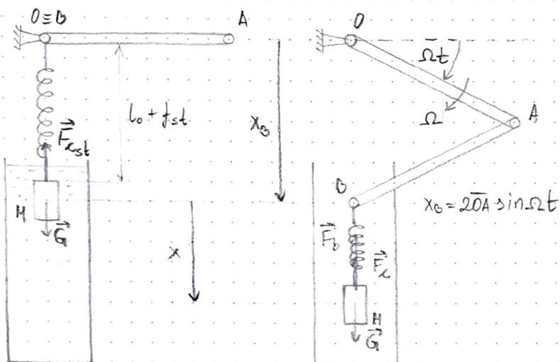
$$c = 0,5 \frac{\text{N}}{\text{cm}} = 0,5 \cdot 100 \frac{\text{N}}{\text{m}} = 50 \frac{\text{N}}{\text{m}}$$
