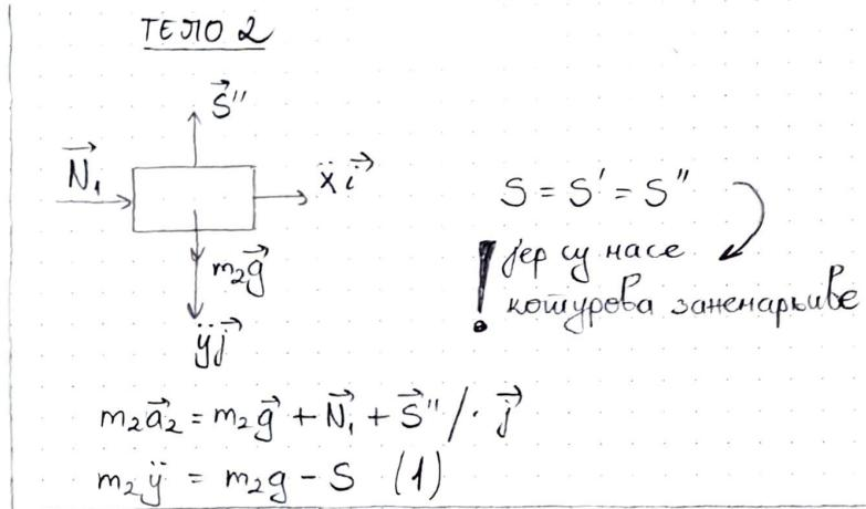
$$m \vec{a}_c = m_1 \vec{g} + \vec{N} + m_2 \vec{g} + \vec{S} + \vec{S}' / \vec{i}, \quad m = m_1 + m_2, \quad a_{cx} = \ddot{x} \Rightarrow \text{ЈЕДНО УЕРЗАЊЕ У ПРАВЦУ } \vec{i}$$
