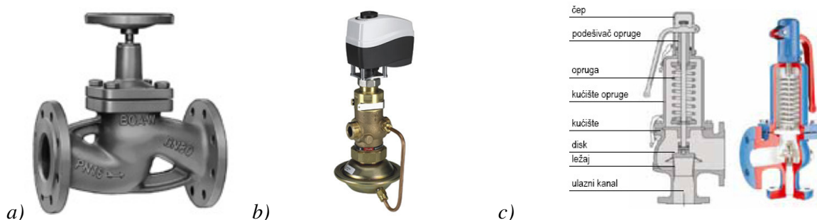
Slika 6.39 Regulacioni ventili: a) ručni regulacioni ventil, b) regulator protoka sa motornim pogonom, c) sigurnosni ventil sa oprugom
