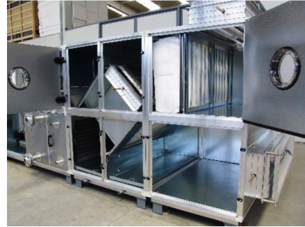
Slika 7.39 Izgled komora sastavljenih od različnih sekcija
