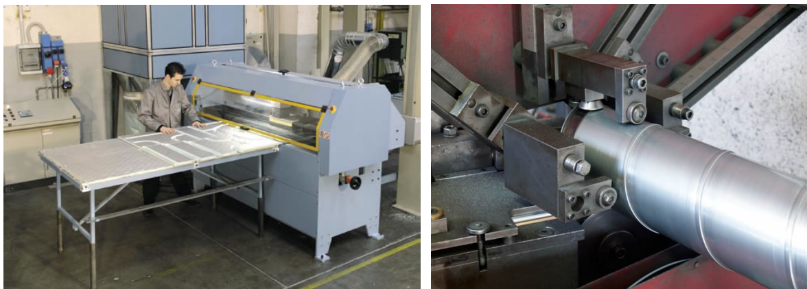
Slika 3.4 Proizvodnja kanala
