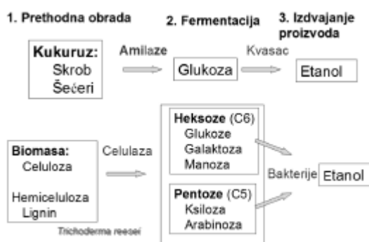
Слика 6.8: Технолошки процес производње етанола из биомасе
