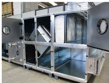
Slika 7.25 Izgled komora sastavljenih od različitih sekcija
