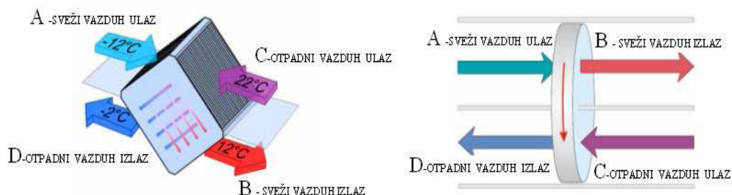
Slika 8.2 Šematski prikaz strujanja vazduha kroz pločasti rekuperativni razmenjivač toplote (levo) i rotacioni regenerativni razmenjivač toplote (desno)
