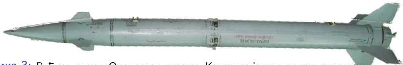
Слика 3: Вођена ракета Оса земља-ваздух. Концепција управљања предњим аеродинамичким површинама.
