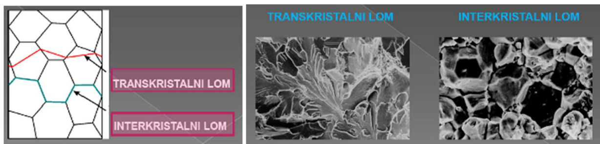
Слика 6: Начини ширења кртог лома – десно СЕМ микрофотографија лома приказаних на скици
