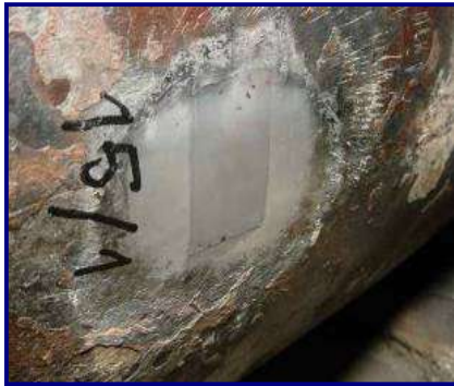
Слика 4: Испитивање микроструктуре методом реплика а) Место „узимања“ реплика на компоненти; б) Реплике пресвучене („напарене“): златом, алуминијумом, графитом
