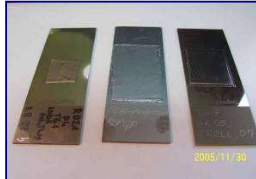
Слика 4: Испитивање микроструктуре методом реплика а) Место „узимања“ реплика на компоненти; б) Реплике пресвучене („напарене“): златом, алуминијумом, графитом
