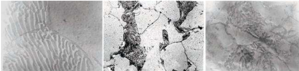
а) ОМ у полазном (АУ) стању, ТЕМ, увећање 20000X
