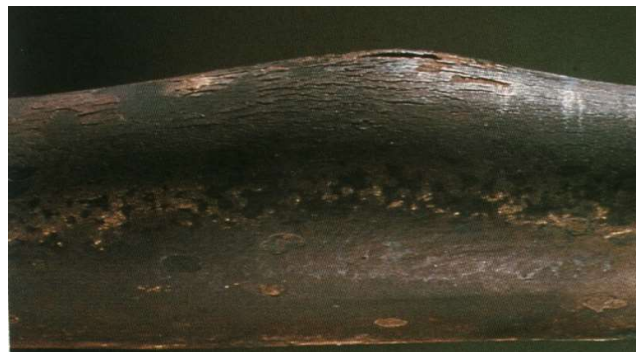
Слика 2.11. Дуготрајно прегревање: а) узрок – директно излагање пламену (локална топла зона) б) узрок – дебеле насlage на унутрашњој површини
