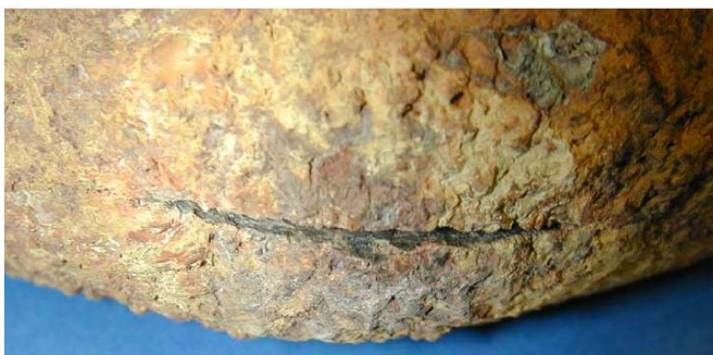
Слика 2.11. Дуготрајно прегревање: а) узрок – директно излагање пламену (локална топла зона) б) узрок – дебеле насlage на унутрашњој површини
