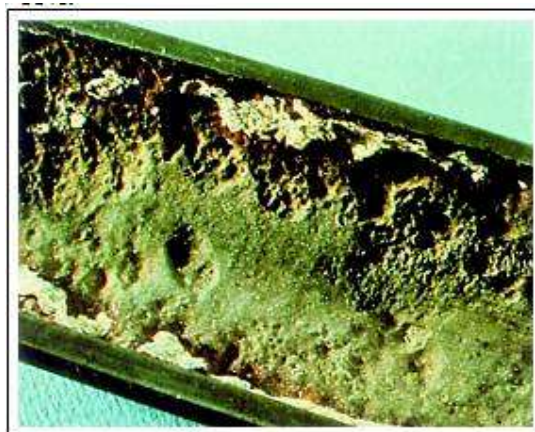
Slika 18. Karakterističan izgled cevi napadnute kaustičnom korozijom, vidljiva su nepravilna udubljenja i beli talog soli
