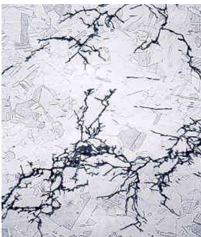
Slika 24. Interkristalna prsline usled naponske korozije (x500 Inconel)
