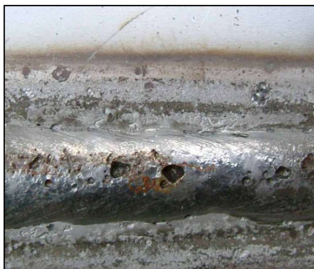
Slika 22: Za zavarivanje Cr-Ni čelika E postupkom upotrebljen je dodatni materijal koji ima manju korozionu postojanost
