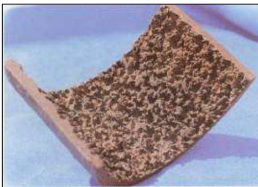
Slika 19. Kiselinska korozija: a – makro izgled; b - oštećenje izazvano nepropisnim hemijskim čišćenjem uz pomoć kiselina
