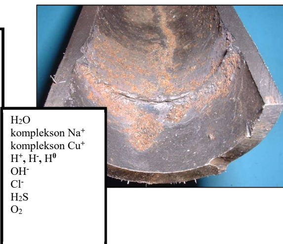
Slika 3.52. Neki oblici korozionih oštećenja koji mogu da se nađu u okolini zavarenog spoja
