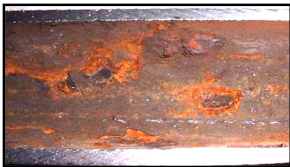
Slika 19. Kiselinska korozija: a – makro izgled; b - oštećenje izazvano nepropisnim hemijskim čišćenjem uz pomoć kiselina
