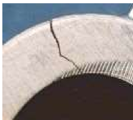
Slika 26. Izgled naponske korozije izazvane zaostalim naponima usled savijanja lima (austenitno–feritni (dupleks) Cr-Ni čelik X2CrNiMoN 22-5-3 čelik)
