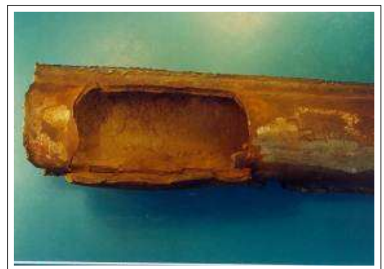
Slika 33. Vodonični plikovi na površini austenitnog čelika; Karakterističan "prozorski" lom
