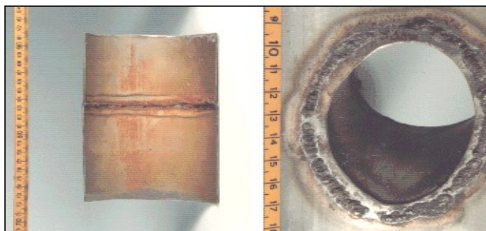
Slika 44. Piting i korozija u zazorima u zavarenom spoju nerđajućeg celika 316, u toploj vodi ( 90^{\circ}\text{C} , \text{pH}=7,2 , 30 ppm \text{Cl}^- )
