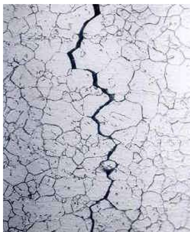
Slika 25. Naponska korozija u hloridnoj sredini austenitnog čelika 316, (x300)
