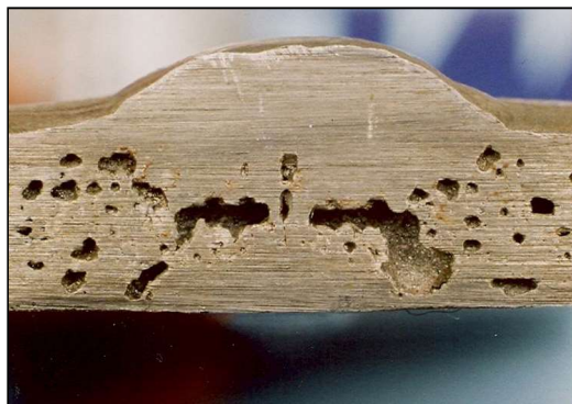
Slika 23: Austenitni čelik AISI 304 - Na mestu reza u agresivnoj sredini, korozija počinje na mestima linijskih uključaka
