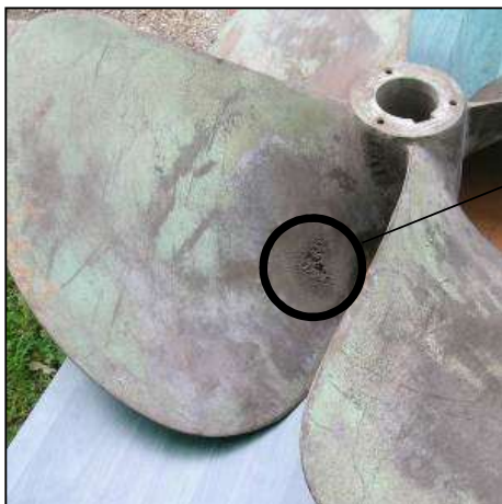
Slika 46 Kavitaciona korozija lopatice brodske elise
