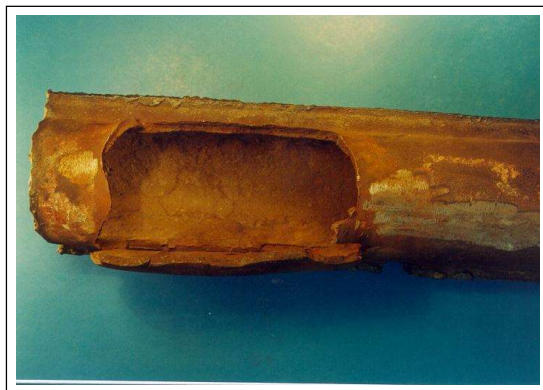
Slika 3.34A. Karakterističan "prozorski" tip vodoničnog korozionog cevi
