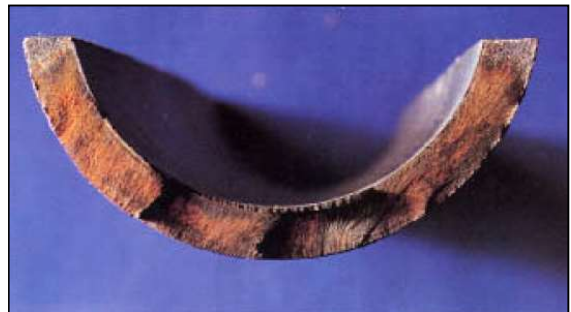
Slika 30B. Korozioni zamor: površina loma
