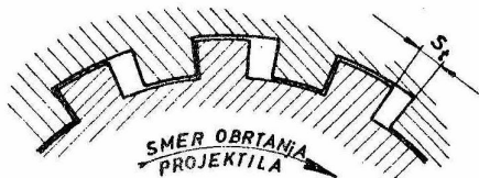
Slika 7.3. Trošenje zuba vodećeg prstena
