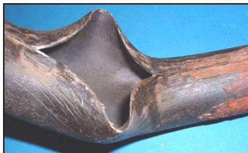
Slika 9.23: Lom usled puzanja: a) šematski prikaz mehanizama loma usled puzanja, b) primer loma cevi usled puzanja sa izraženom plastičnom deformacijom
