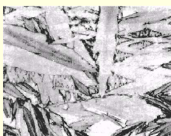
Pločasti kristali martenzita obrazuju se kod visokougleničnih čelika ( > 0,8\% \text{ C} ).
