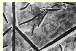
perlitna osnova (sivo) sa lamelama grafita (tamno).
