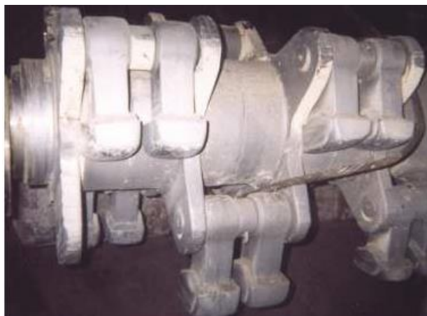
Slika 1. Prevlake nanete navarivanjem na čekiće u cilju sprečavanja habanja
