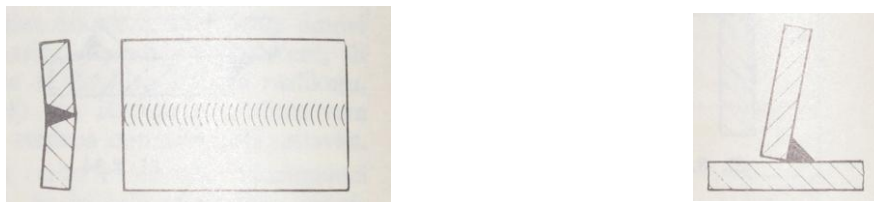
Slika 8. Deformacije zavarenog spoja
