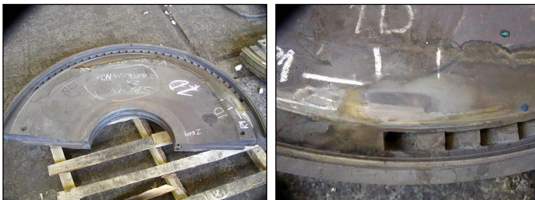
Slika 8. Dijafragma 1D nakon sanacije
