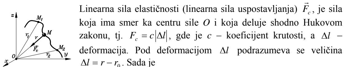
Linearna sila elastičnosti (linearna sila uspostavljanja)  $\vec{F}_c$ , je sila koja ima smer ka centru sile  $O$  i koja deluje shodno Hukovom zakonu, tj.  $F_c = c|\Delta l|$ , gde je  $c$  – koeficijent krutosti, a  $\Delta l$  – deformacija. Pod deformacijom  $\Delta l$  podrazumeva se veličina  $\Delta l = r - r_0$ . Sada je
