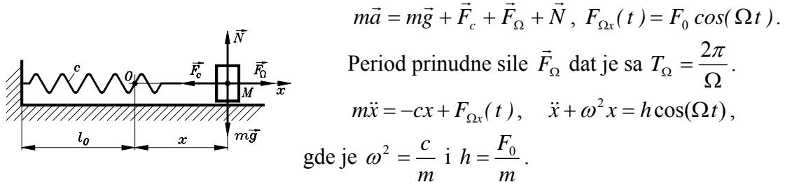
Homogeni deo rešenja je  $x_h = \bar{C}_1 \cos(\omega t) + \bar{C}_2 \sin(\omega t)$ , a  $x_p$  naziva se partikularni integral i njegov oblik je vezan za odnos veličina  $\omega$  i  $\Omega$ . Sa fizičke tačke gledišta, ovaj deo opšteg integrala  $x$  posledica je dejstva prinudne sile  $\vec{F}_\Omega$ , zbog čega se naziva prinudna oscilacija tačke.
