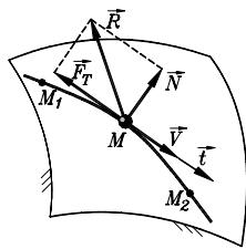
vezi koju čini površ nekog tela. Reakcija veze  $\vec{R}$ , ima dve komponente:  $\vec{N}$  u pravcu normale i  $\vec{F}_T$  u pravcu tangente na putanju tačke. Ako otpor kretanju tačke  $M$  po površi potiče od suvog trenja, sila trenja klizanja  $\vec{F}_T$  je  $\vec{F}_T = -\mu N \frac{\vec{V}}{V} = -\mu N \operatorname{sgn} \dot{s} \vec{t}$ . Rad sile trenja klizanja  $\vec{F}_T$  pri
