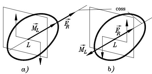
U tom slučaju kaže se da je sistem sila sveden na dinamu  $(\vec{F}_R; \vec{M}_L)$ , pri čemu se ta dva kolinearna vektora nalaze na osi udaljenoj u odnosu na tačku  $O$  za rastojanje
