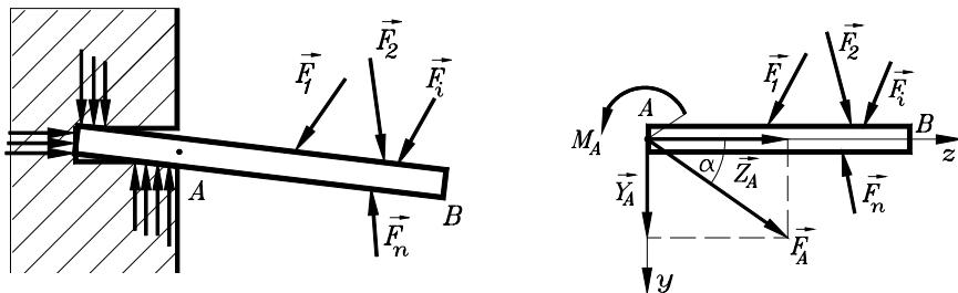
Sila  $\vec{F}_A$  i moment uklještenja  $M_A$  nazivaju se reakcije uklještenja. Dakle, postoji tri nepoznate veličine koje treba odrediti i to su: intenzitet  $F_A$ , ugao  $\alpha$  koji sila  $\vec{F}_A$  zaklapa sa osom  $Az$  i projekcija momenta uklještenja  $M_A$  na osu  $Ax$ .
