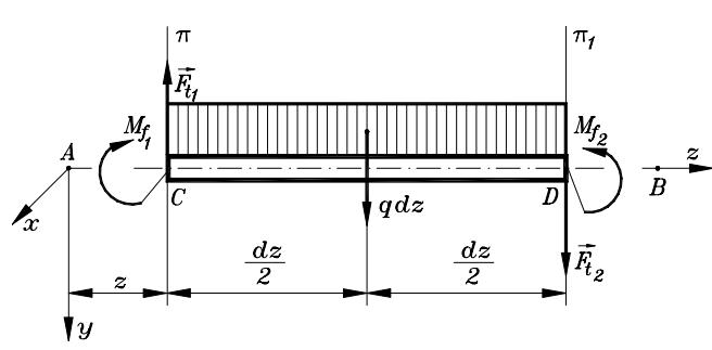
Između specifičnog opterećenja  $q$ , transverzalne sile  $F_t$  i momenta savijanja  $M_f$ , na nekom delu nosača, mogu se uspostaviti diferencijalne veze. Neka se posmatra prosta gredu  $AB$  opterećena specifičnim opterećenjem i poprečnim koncentrisanim opterećenjima, upravnim na pravac grede.
