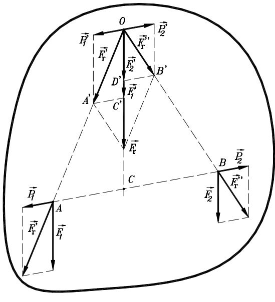
Posmatra se sistem od dve paralelne sile istog smera  $\vec{F}_1$  i  $\vec{F}_2$ , koje deluju u tačkama  $A$  i  $B$  tela. Može se pokazati da se ovaj sistem sila može zameniti jednostavnijim, njemu ekvivalentnim sistemom sučeljnih sila za koji se zna da ima rezultantu.
