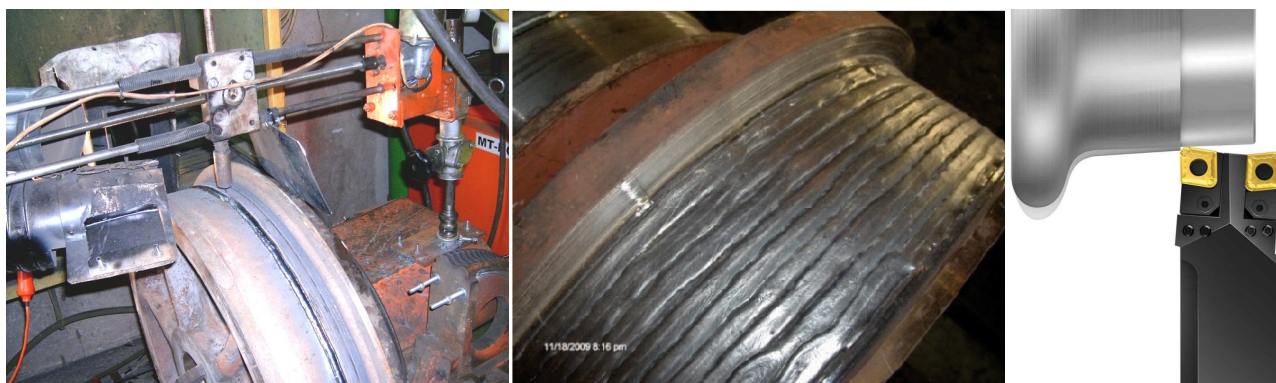
Slika 6 Reparacija površinski oštećenog – pohabanog venca točka postupkom navarivanja
