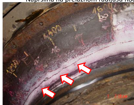
Naprslina na prelaznom radijusu R80
