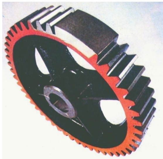
Slika 3 Reparacija cilindričnog zupčanika sa pravim zupcima
