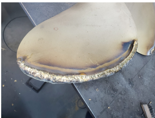
b) Navarivanje propelera od bronce
