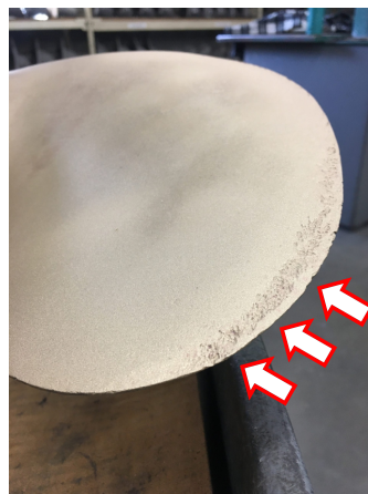
a) Oštećenja u vidu kavitacije
