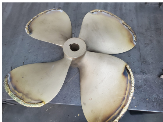
b) Navarivanje propelera od bronce
