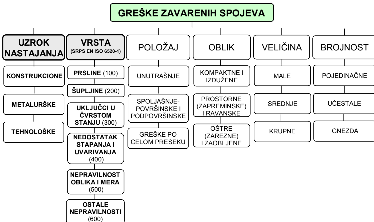
Slika 16. Klasifikacija grešaka zavarenih spojeva
