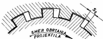
Slika 3.3. Trošenje zuba vodećeg prstena
