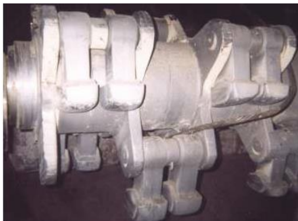
Slika 1. Prevlake nanete navarivanjem na čekice u cilju sprečavanja habanja
