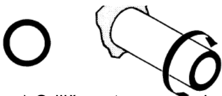
c) Odlična otpornost pri uvijanju (veća sa većim D)
