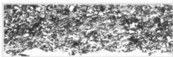
Gasno plamena metalizacija, Fini 80/20 NiCr prah
