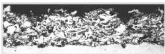
Gasno plamena metalizacija, Grubi 80/20 NiCr prah
