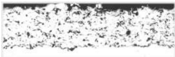
Plazma metalizacija, Grubi 80/20 NiCr prah
