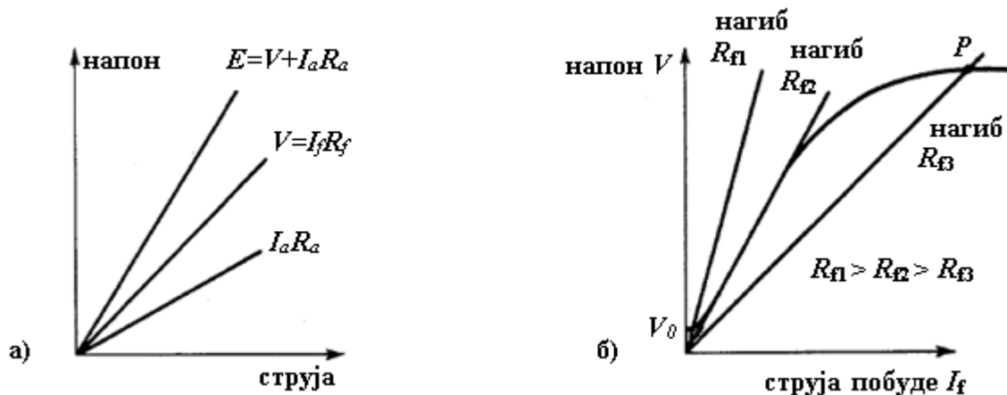
Слика 4.17 Карактеристике неоптерећеног генератора, а) без засићења и б) са засићењем.
