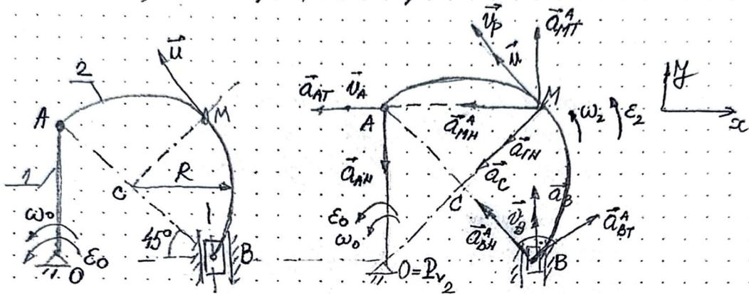
Relativno kretanje tačke  $M$  je po polukružno savijenoj žici, telu 2. Vektor relativne brzine  $\vec{v}_r$  je u posmatranom trenutku:  $\vec{v}_r = \vec{u}$ , a relativno ubrzanje:
