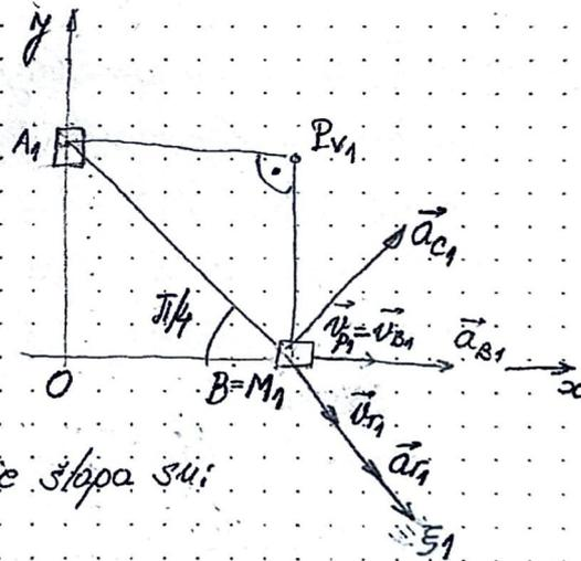
Ugaozna brzina  $\omega = \dot{\varphi}$  i ugaozna ubrzanje štapa su:
