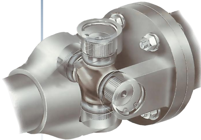
Asinhron, krut zglobni prenosnik
