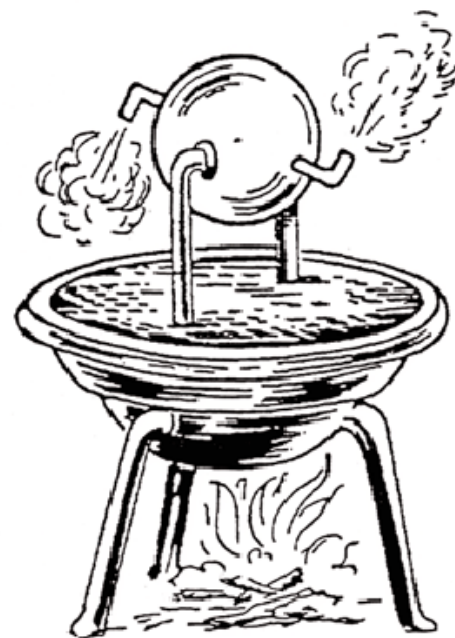
Aeolipile, Херонов млазни мотор
