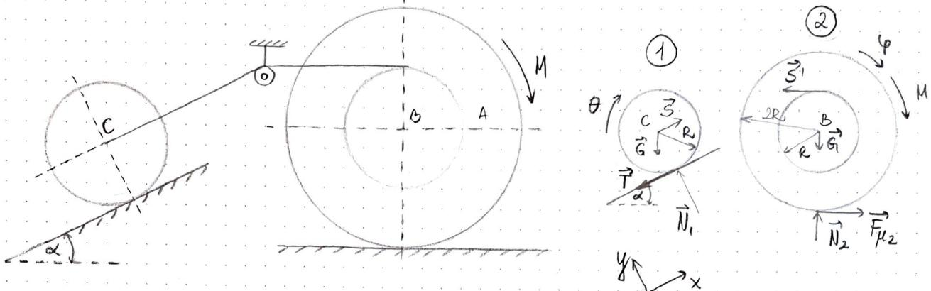
$$(2) \frac{d\vec{\omega}}{dt} + \vec{U}_Q \times \frac{G}{g} \vec{U}_C = \vec{M}_Q \Rightarrow \text{ЗАКОН ПРОМЕЊЕ МОМЕНТА КОЈИ КР. ЗА ПОКРЕТНИ ПОЈИ } Q$$
