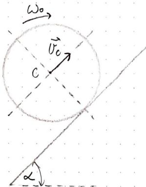
\* Цилиндар проклизава у почетку кретања и због што тачка додира између цилиндра и подлоге нује тренутни пол брзина ( $v_A \neq 0$  аж.  $v_A > 0$ ). У току кретања брзина тачке додира се смањује и постизаје  $v_A = 0$  након чега се цилиндар крчија без клизања!
