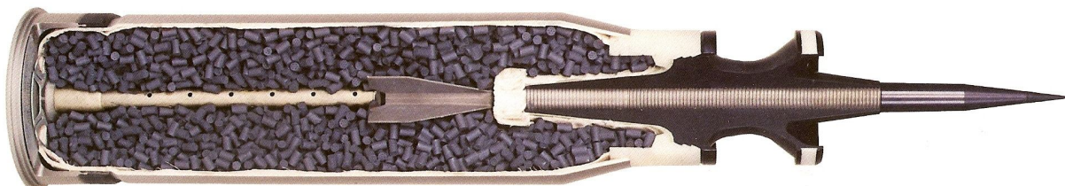
Podkalibarni projektil 120 mm M829 APFSDS-T
