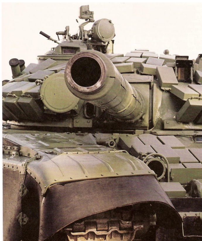
Modernizovani tenk T-72 sa eksplozivnim reaktivnim oklopom
