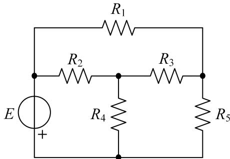
**REŠENJE:** Primenom metode konturnih struja, za konture prikazane na slici dobija se
