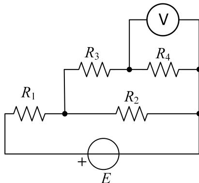
**REŠENJE:** Otpornost idealnog voltmetra je beskonačno velika,  $R_v \rightarrow \infty$  pa ga možemo zameniti otvorenom vezom. Tada je struja kroz otpornik  $R_4$
