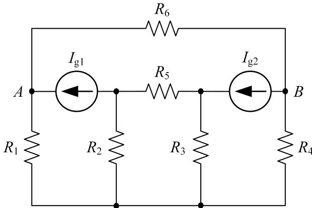
**REŠENJE:** U ovom kolu postoje idealni strujni generatori, pa se konture moraju odabrati na takav način da je svaki strujni generator obuhvaćen samo jednom konturom. Za konture odabране kao na slici, pišemo jednačine:
