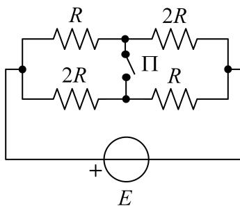
**REŠENJE:** Kako bismo odredili snagu idealnog naponskog generatora potrebno je odrediti struju kroz njegove priključke. Kada je prekidač otvoren, tada je ekvivalentan otpor koji idealni naponski generator vidi
