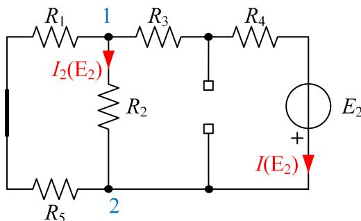
Zadatak može biti rešen na više načina (za samostalni rad uraditi preko metode potencijala čvorova ili konturnih struja). Ovde će biti primenjene jednostavne transfiguracije otporničke mreže. Primetimo da je otpornost koju vidi idealni naponski generator
