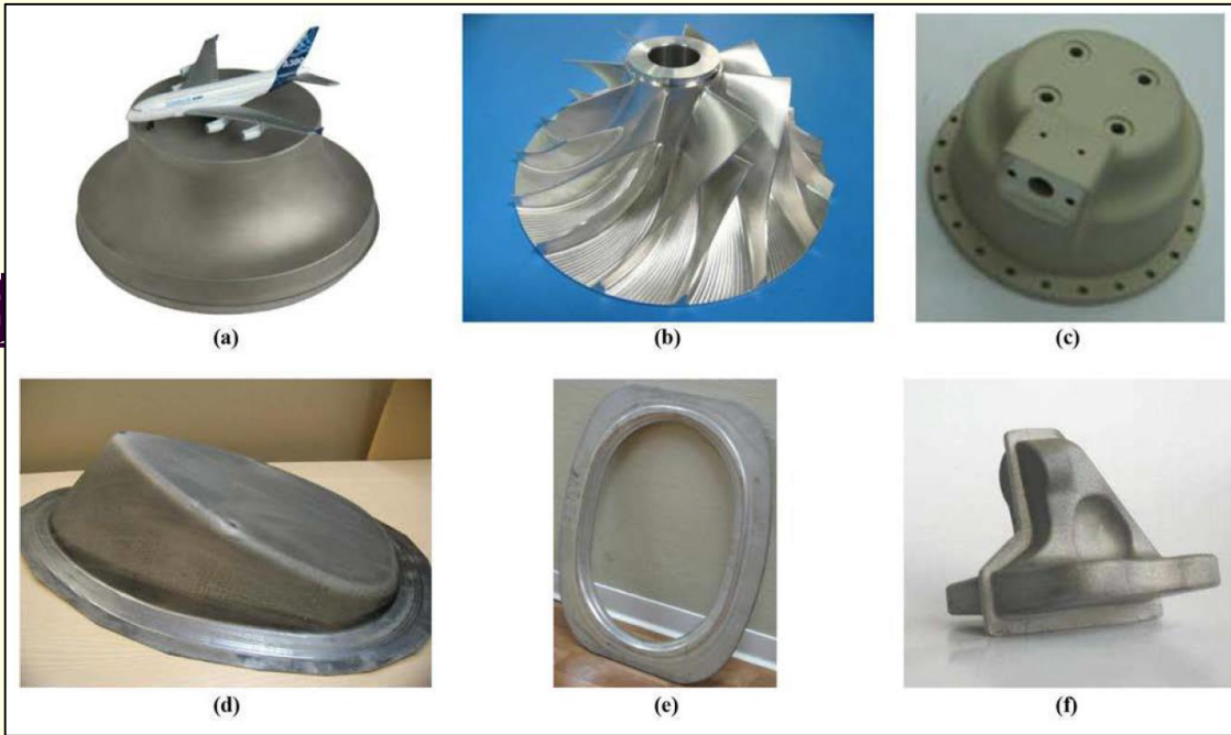
a, c) Deo kompresora; b) impeler od legure sa Li; d, e) delovi letelica; f) otkovak
