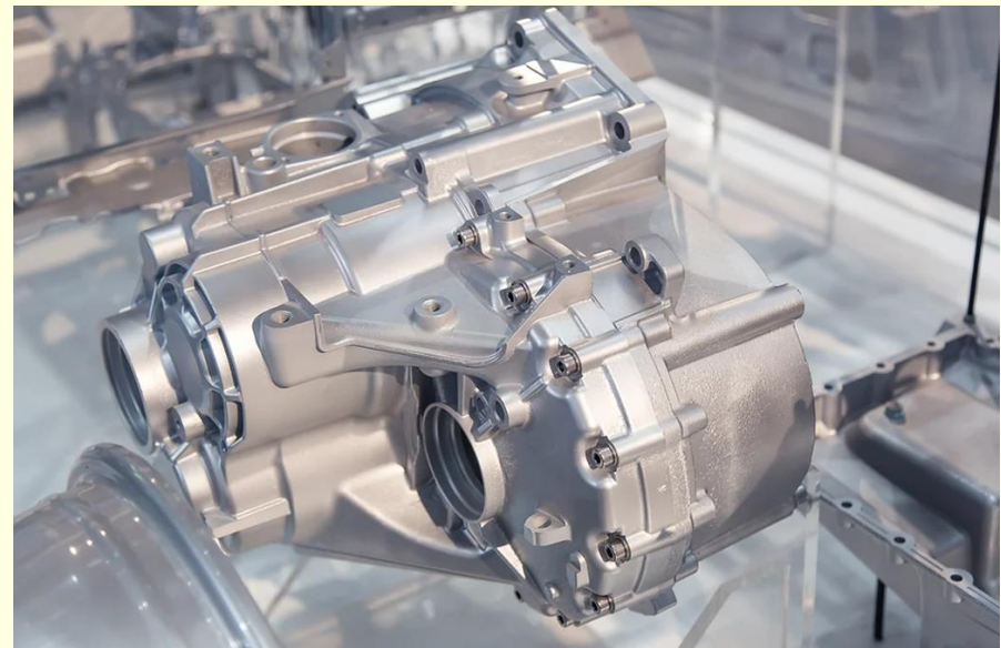
Kućište reduktora od livene legure Mg
