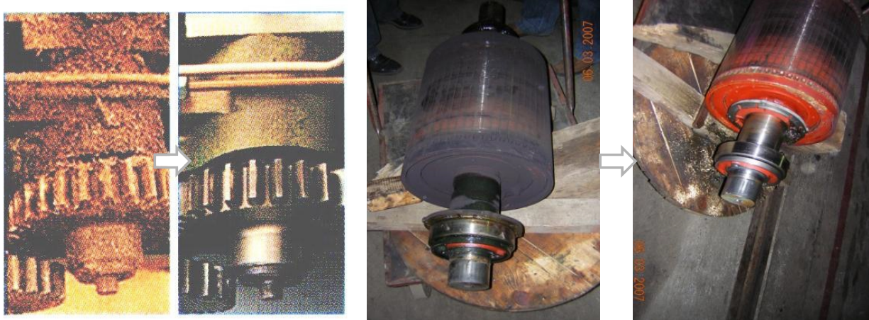
Slika 4 Mašinski sklopovi pre i posle čišćenja metodom suvog leda
