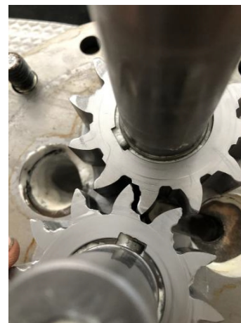
Slika 10 Ekstreman primer razaranja aktivnih bokova zubaca kod zupčastog para sa jednim smerom obrtanja
