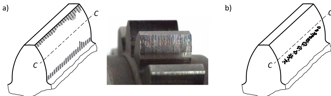
Slika 4 a) Brusno habanje bokova zubaca b) razaranje usled površinskog zamora
