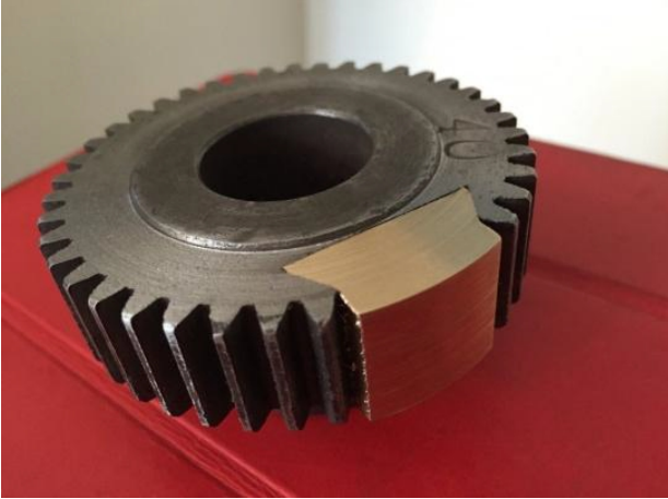
Izgled repariranog zupčanika
