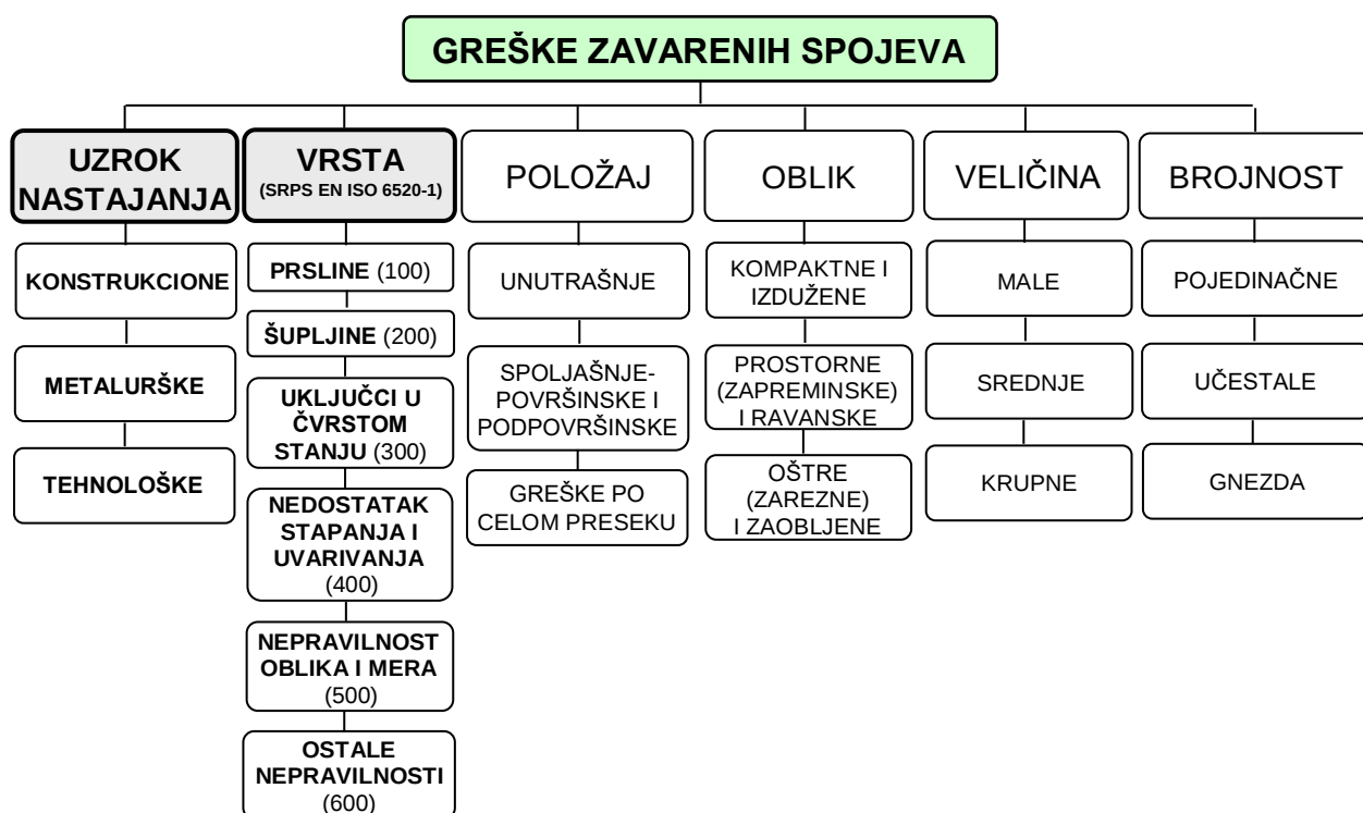
Slika 16. Klasifikacija grešaka zavarenih spojeva
