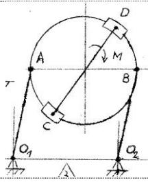
7.44. Laki štapovi  $O_1A$  i  $O_2B$ , dužine  $2R$ , mogu se obrnati oko horizontalnih paralelnih osa  $O_1$  i  $O_2$ . U tačkama A i B zglobom je vezan kružni prsten poluprečnika R i mase M. Po glatkom prstenu mogu se kretati klizaci C i D, svaki mase m (spojeni su lakinim štapom CD na koji dejstvuje spreg sila momenta M). Za opisani dinamički sistem odrediti prve integrale kretanja.
