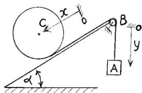
7.23. Disk mase m poluprečnika r nalazi se na glatkoj strmoj ravni nagiba  $\alpha=45^\circ$ . Na disk je namotano nerastegljivo uže čiji je drugi kraj vezan za teret A mase m.. Koturača B je zanemarljive mase, poluprečnika b. Odrediti: a) za date generalisane koordinate x, y diferencijalne jednačine kretanja, b) ubrzanje tereta A, c) silu u užetu. Sistem se nalazi u vertikalnoj ravni.
