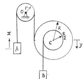
7.31. Uže koje je prebačeno preko diska 0 (disk 0 je zanemarljive mase i poluprečnika  $r$ ) spaja teret A (mase  $m_A=m$ ) sa koaksijalnim diskom C (mase  $m_C=5m$ , momenta inercije  $J_{cz}=2mR^2$ , poluprečnika  $R/2$  i  $R$ ). Uže koje je prebačeno preko manjeg diska (koaksijalnog diska) nosi na svom drugom kraju teret B mase  $m_B=4m$ . Odrediti u odnosu na date generalisane koordinate  $x$  i  $y$  diferencijalne jednačine kretanja. Koliko je ubrzanje tereta B?
