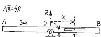
7.11. Sistem je u vertikalnoj ravni ( $0z$  je na pravcu vertikale). Za nepomični zglob  $0$  šarnirno je vezan u svom središtu šuplji štap AB koji rotira oko horizontalne ose. Unutar štapa AB može da se kreće štap, sa središtem masa u T, dužine  $R$  i mase  $m$  ( $0T=x$ ). Štap AB je mase  $3m$  i dužine  $4R$ . Za date generalisane koordinate  $\theta$  i  $x$  odrediti diferencijalne jednačine kretanja.
