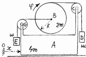
7.15. Telo A, mase 4m, klizi bez trenja po horizontalnoj podlozi. Disk B, mase 2m i poluprečnika R (kontrolja se bez klizanja po telu A), vezan je užetom za teg D mase m, a drugim užetom (u svom centru) vezan je za teg E mase m. Mase užadi i koturača C i G (obe poluprečnika r) zanemariti. Odrediti, u odnosu na date generalisane koordinate x i  $\varphi$ , diferencijalne jednačine kretanja, kao i ubrzanje tela A.
