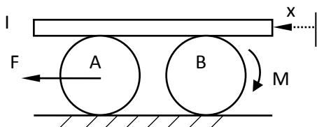
7.2. Homogeni diskovi, svaki mase  $m$  i poluprečnika  $R$ , kotrljavaju se bez klizanja, a po njima može da se kreće ploča I mase  $2m$ ; između ploče i diskova nema proklizavanja. Odrediti: 1) kinetičku energiju sistema, 2) generalisane sile za koordinatu  $x$ , 3) Lagranževu diferencijalnu jednačinu kretanja druge vrste za koordinatu  $x$ , 4) ubrzanje ploče tj.  $a_x=?$
