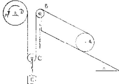
7.47. Teret E mase m vezan je za centar pokretnog diska C poluprečnika r (disk C je zanemarljive mase). Uže je namotano na disk D poluprečnika R i mase m, zatim obuhvata disk C, disk B (zanemarljivog poluprečnika i mase) i ide paralelno strmoj ravni (nagiba  $\alpha=30^\circ$ ) i namotano je zatim na disk A, mase  $2m$  i poluprečnika R (disk A se kotrlja bez klizanja). Odrediti ubrzanja tereta E i središta diska A, ako na disk D dejstvuje moment sprega sila  $M=2mgR$ .
