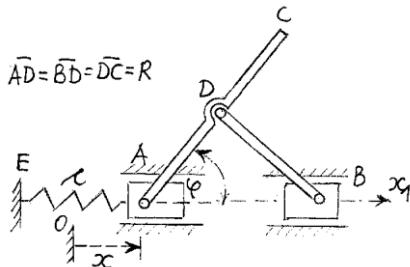
7.17. Klizači A (mase 2m) i B (zanemarljive mase), mogu da klize po glatkoj horizontalnoj vodici. Klizač A je horizontalnom oprugom krutosti c vezan za vertikalni zid. U tačkama A, B i D su zglobne veze. Štap AC je dužine  $2R$  ( $AD=DC=R$ ) i mase m, a štap BD je dužine  $R$  (zanemarljive mase). Za date generalisane koordinate x i  $\varphi$  odrediti diferencijalne jednačine kretanja. Kada je  $x=0$  opruga je ne deformisana.
