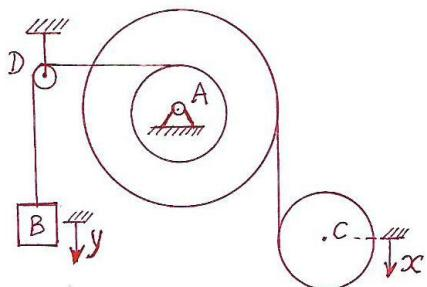
7.5. Koaksijalni disk A poluprečnika  $R$ ,  $2R$ , mase  $2m$  i kraka inercije  $i=R$  spojen je užetom za teg B, posredstvom diska D (bez mase, poluprečnika  $r$ ), a drugim užetom za disk C (mase  $m$ , poluprečnika  $R$ ). Ako na koaksijalni disk A dejstvuje spreg sila momenta  $M=mgR$ , odrediti u odnosu na date (vertikalne) generalisane koordinate  $x$  i  $y$ : a) diferencijalne jednačine kretanja, b) silu u užetu iznad tega B.
