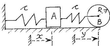
7.13. Sistem se sastoji iz tereta A mase  $m$ , diska B mase  $m$  i dve opruge istih krutosti  $c$ , vezanih prema slici. Teret A klizi bez trenja, disk B se kotrlja bez klizanja po horizontalnoj vezi; spreg sila momenta  $M$  dejstvuje na disk u smjeru kazaljke na časovniku. Kada je  $x=0$ ,  $\psi=0$  opruge su nenaopregnute. Za date generalisane koordinate  $x$  i  $y$  odrediti diferencijalne jednačine kretanja.
