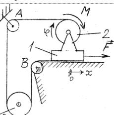
7.30. Telo 1, mase  $m$ , leži na glatkoj horizontalnoj ravni, a oko osovine (pričvršćene za telo 1) može da rotira disk 2 mase  $m$  i poluprečnika  $R$ . Pomoću sistema užadi i koturova A i B (zanemarljivih masa) tela 1 i 2 su spojena za disk 3 mase  $m$  i poluprečnika  $R$ . Na telo 1 dejstvuje horizontalna sila  $F=2mg$ , a na disk 2 spreg sila momenta  $M=2mgR$ . Odrediti za date generalisane koordinate  $x$ ,  $\varphi$  diferencijalne jednačine kretanja.
