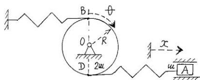
7.33. Disk poluprečnika R i mase  $2m$  može da se obrće oko horizontalne ose 0, a klizač A mase m može da se kreće po glatkim horizontalnim vodicama. U tačkama B i D diska vezane su horizontalne opruge krutosti c. Odrediti u odnosu na date generalisane koordinate x i  $\theta$  (ugao  $\theta$  se meri od vertikale) u linearnom slučaju ( $\sin\theta \approx \theta, \cos\theta \approx 1$ ) diferencijalne jednačine kretanja. Kada je  $x=0, \theta=0$ , opruge su nenaopregnute.
