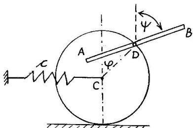
7.9. Za obodnu tačku D diska mase  $4m$  i poluprečnika  $R$ , koji se bez klizanja kotrlja po horizontalnoj ravni, zglobno je za svoje središte vezan štap AB dužine  $2R$  i mase  $m$ . Centar diska je horizontalnom oprugom krutosti  $c$  vezan za vertikalni zid. Za date generalisane koordinate  $\varphi$ ,  $\psi$  odrediti diferencijalne jednačine kretanja. Kada je  $\varphi=0$  opruga je nedeformisana.
