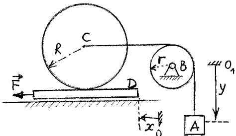
7.8. Telo D, mase  $m$ , klizi bez trenja po horizontalnoj podlozi. Centar diska C, mase  $m$  i poluprečnika  $R$  (disk se kotrlja bez klizanja po telu D), vezan je užetom za teg A mase  $m$ . Koturača B je zanemarljive mase i poluprečnika  $r$ . Ako na telo D dejstvuje horizontalna sila  $F=2mg$ , odrediti, u odnosu na date generalisane koordinate  $x$  i  $y$ , diferencijalne jednačine kretanja kao i ubrzanja tega A i tela D.
