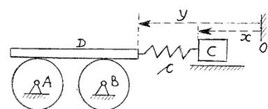
7.19. Po diskovima se kreće letva D mase m i dužine L (između letve i diskova nema proklizavanja). Diskovi su svaki mase m i poluprečnika R. Letva D vezana je oprugom krutosti c za teret C mase m, koji se kreće po glatkoj vezi. Nenapregnuta dužina opruge je R. Odrediti: (1) u odnosu na date generalisane koordinate x i y diferencijalne jednačine kretanja, (2) konačnu jednačinu kretanja tereta C, tj.  $x(t)=?$  U početnom trenutku kada je sistem mirovao  $x(0)=0$ ,  $y(0)=\frac{R}{2}$ .
