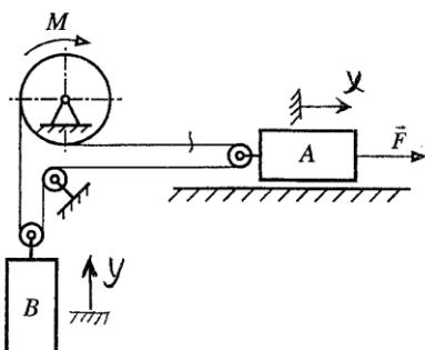
7.22. Sistem je u vertikalnoj ravni. Tereti A i B su svaki mase m. Koturače su zanemarljive mase. Sistem je vezan pomoću lako neistegljivog užeta čija su oba kraja namotana na laki disk poluprečnika R. Na teret A, koji se kreće horizontalno, dejstvuje sila  $F=3mg$ . Na disk deluje spreg momenta  $M=4mgR$ . Za date generalisane koordinate x, y odrediti diferencijalne kao i konačne jednačine kretanja, ako je u početnom trenutku sistem mirovao,  $x(0)=y(0)=0$ .
