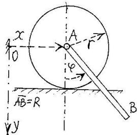
7.35. Za središte A diska mase m i poluprečnika r, koji se kotrlja bez klizanja po horizontalnoj ravni, zglobno je vezan štap AB dužine R i mase m. Za date generalisane koordinate x,  $\varphi$  odrediti: 1) diferencijalne jednačine kretanja, 2) u linearnom slučaju ( $\sin\varphi \approx \varphi, \cos\varphi \approx 1$ ) konačne jednačine kretanja ako je u početnom trenutku sistem mirovao  $\varphi(0)=\varphi_0, x(0)=0$ .
