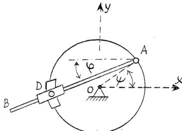
7.21. Vertikalni disk mase  $2m$  i poluprečnika  $R$  može da rotira oko horizontalne  $Oz$  osovine. Štap AB dužine  $4R$  i mase  $3m$  krajem A vezan je zglobom za disk. Štap pri kretanju prolazi kroz obrtno klizno ležište D (unutar kojeg klizi bez trenja), ležište D može da se kreće po obodu diska. Za date generalisane koordinate  $\psi$ ,  $\varphi$  odrediti diferencijalne jednačine kretanja.
