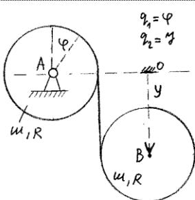
7.6. Sistem je u vertikalnoj ravni. Uže koje je prebačeno preko diska A ima na svom drugom kraju disk B. Diskovi A i B su mase  $m$  i poluprečnika  $R$ . Odrediti diferencijalne jednačine kretanja u odnosu na date generalisane koordinate  $\varphi$  i  $y$ . Koliko je ubrzanje centra diska B?
