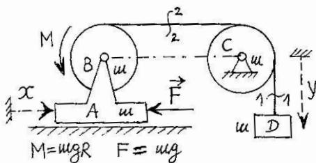
7.20. Na telo A, mase m, koje se bez trenja kreće po horizontalnoj podlozi, dejstvuje konstantna horizontalna sila  $F=mg$ . Za telo A vezana je osovina oko koje rotira disk B, poluprečnika R i mase m; na disk B dejstvuje spreg sila momenta  $M=mgr$ . Uže spaja teret D (mase m) i disk B (posredstvom diska C mase m i poluprečnika R). U tački C je zglobna veza. Odrediti: 1) ubrzanja tela A i tereta D, 2) sile u užetu u presecima 1-1, 2-2.
