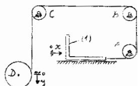
7.10. Ugaonik (1) mase  $m$ , koji bez trenja klizi po horizontali, vezan je užetom (koje je prebačeno preko koturova A, B i C, bez masa i zanemarljivih dimenzija) za disk D mase  $2m$  i poluprečnika  $R$ . Odrediti: 1) kinetičku energiju sistema, 2) generalisane sile, 3) ubrzanje ugaonika ( $a_x=?$ ).
