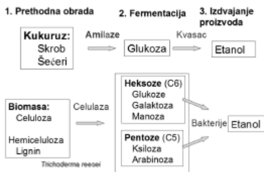
Слика 6.8: Технолошки процес производње етанола из биомасе
