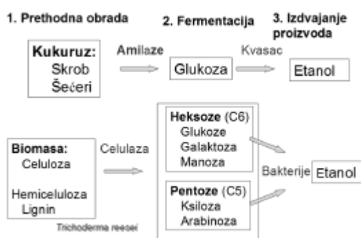
Слика 9.8: Технолошки процес производње етанола из биомасе
