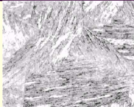
Mikrostruktura paketastog martenzita kod niskougledjenog čelika, uvećano \times 800 .
