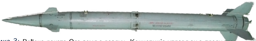
Слика 3: Вођена ракета Оса земља-ваздух. Концепција управљања предњим аеродинамичким површинама.
