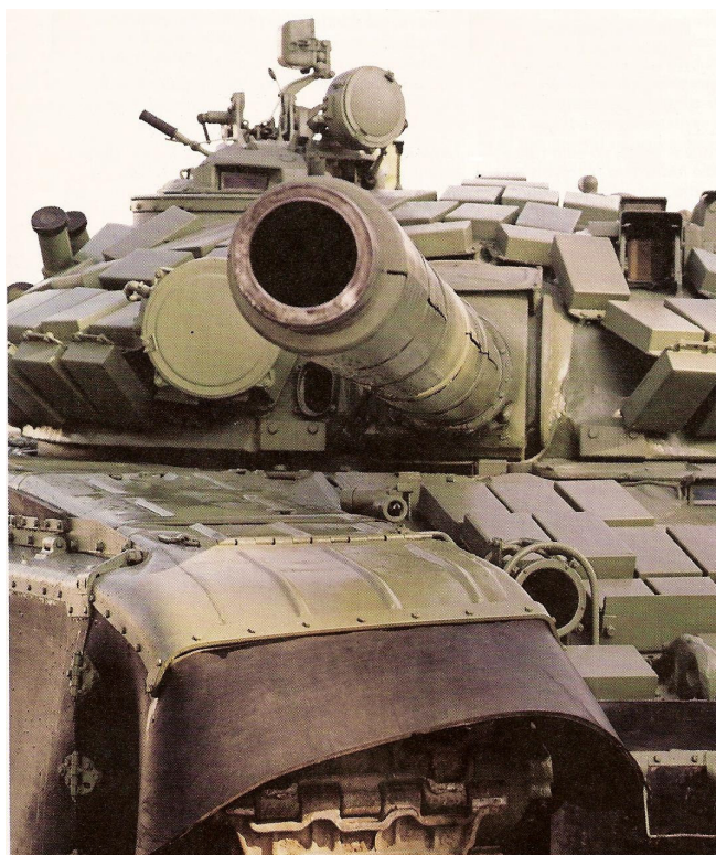
Modernizovani tenk T-72 sa eksplozivnim reaktivnim oklopom
