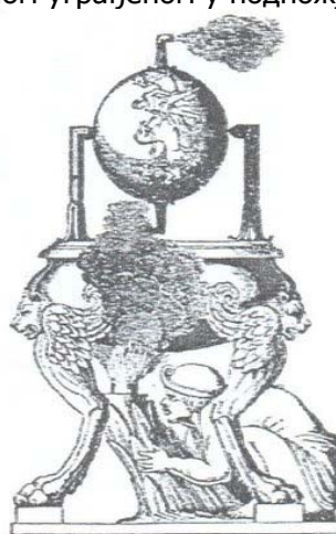
Слика 11. Принцип реакције - Еолипил
