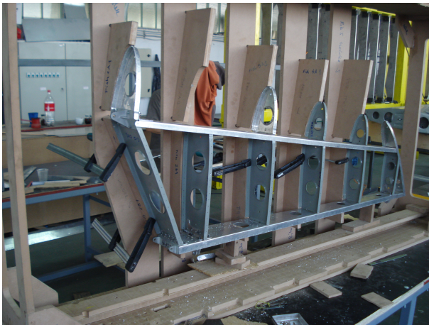
Slika: Sklapanje detalja vertikalnog repa u privremenom alatu
