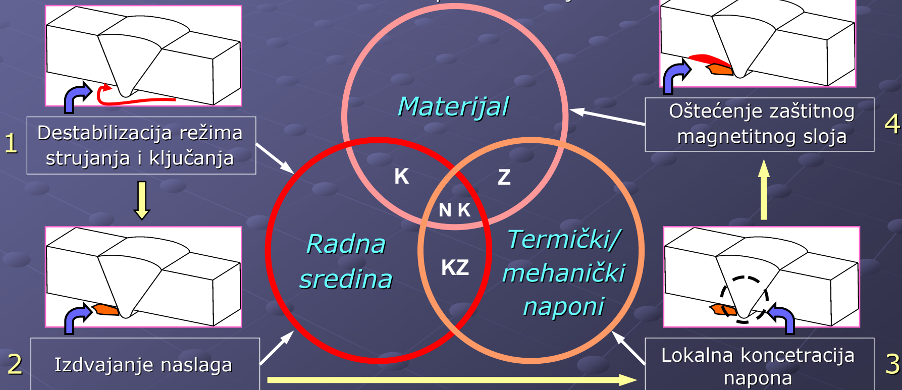
Slika 1: Uticaj grešaka zavarivanja na nepovoljne pojave i fenomene kod kotlovskih cevi
