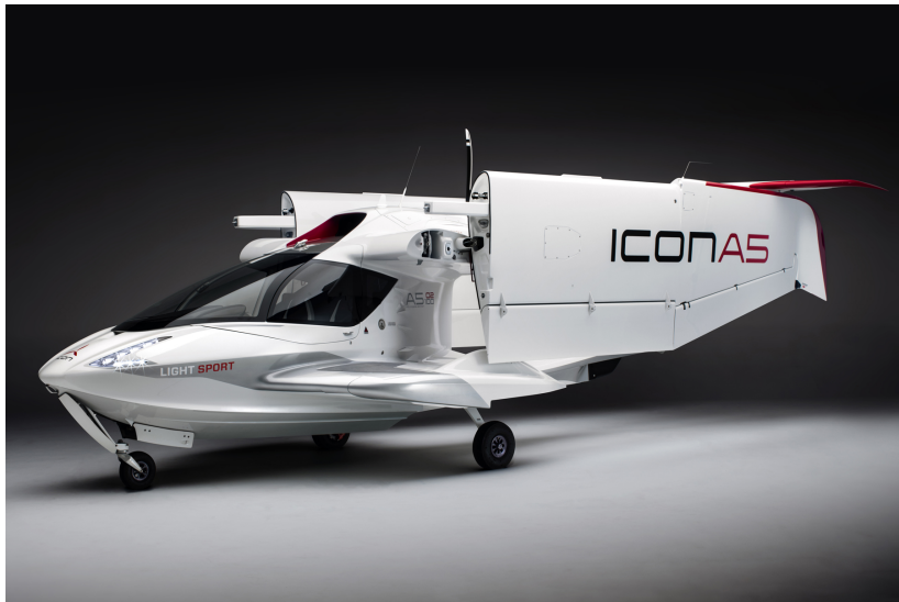
Slika: ICON A5 – kompozitna amfibija
